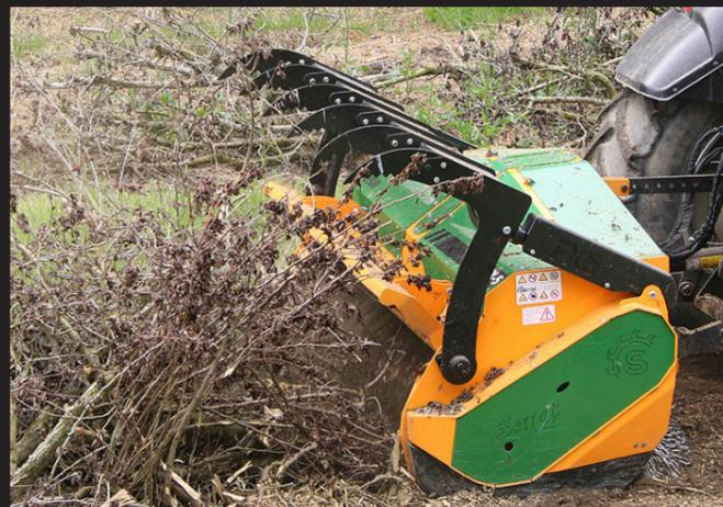
Trituradora forestal adaptable a todo tipo de tractores entre 150 - 230 CV. Equipada con martillos escamoteables, para ramas de cortas, desbroces forestales, fajas auxiliares, monte en pie, etc. Equipada con rotor de diente fijo con sistema FIXE TOP, para madera gruesa y tocones. Esta máquina incorpora todas las opciones posibles de serie necesarias para realizar un óptimo trabajo forestal.
