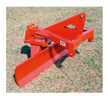
O fácil manejo da Plaina Traseira permite o seu uso nas mais diversas condições e tipos de solo. Os raspadores são reversíveis e tratados termicamente, com alta resistência ao desgaste. A estrutura resistente assegura maior durabilidade.
