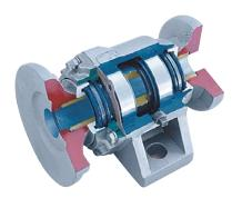
**MANCAIS** com dois rolamentos de rolos cônicos, lubrificados a graxa (CM) ou em banho de óleo permanente - DUROMARK® (DM), que utilizam retentores Duo-Cone, sem vazamentos e sem contaminação por materiais abrasivos. A troca de óleo a cada mil horas economiza lubrificante e mão de obra, evitando paradas diárias.
