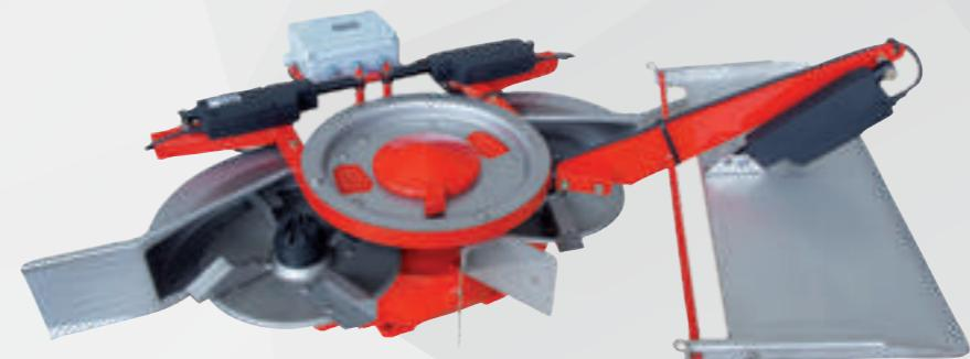
Es un control electrónico que nos permite modificar durante el trabajo el flujo de producto para mantener la dosis programada de kg/ha. aunque se produzcan cambios en la velocidad de avance del tractor (D.P.A.E.)
