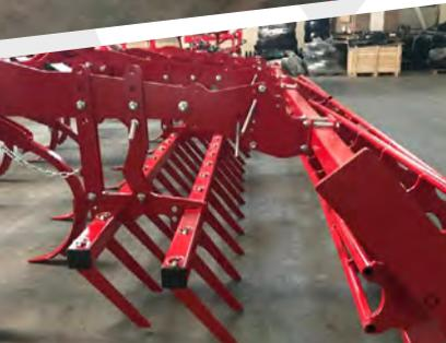
**Rastra de 1 fila:** Colocada tras el rodillo e idealmente en combinación con deflectores, realiza una buena labor de escarda de malas hierbas.
