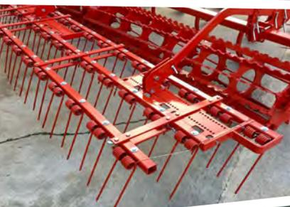
**Rastra de 10 mm con 2 o 3 filas :** Con una longitud de 40 cm y púas de 10 mm, es una rastra ideal, con o sin rodillo, que nivela el suelo y saca las raíces de las malas hierbas a la superficie. Cuando hay mucho residuo vegetal es recomendable que trabaje en flotación.
