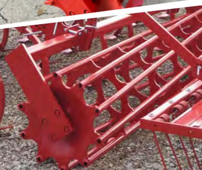
**Rodillo de barras de 480 o 540 mm:** Ideal para el laboreo, incluso en suelos ligeros o ya trabajados, realiza un buen acondicionamiento del suelo sin compactarlo. Funciona en condiciones secas o húmedas. Es el rodillo más sencillo y versátil.
