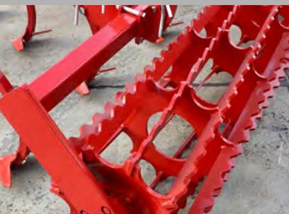
**Rodillo de muescas de 400 o 520 mm:** Con una pletina dentada con muescas agresivas y fabricada en acero ALE, este rodillo agresivo nivela el suelo sin compactarlo. Ideal en condiciones de sequía, desmenuza perfectamente y rompe los terrones de tierra y tritura la materia vegetal en la superficie. No se recomienda en condiciones húmedas y pegajosas, tampoco en terrenos pedregosos.
