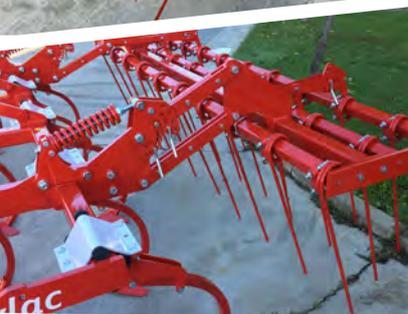
**Rastra de 16 mm de 3 filas :** Con unas púas de 16 mm y 85 cm de longitud de ángulo regulable según el trabajo deseado, esta rastra atraviesa sin dificultad la vegetación más densa. No se puede combinar con un rodillo. Es aconsejable equipar un par de ruedas para un buen control de profundidad.
